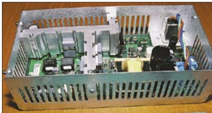
Denna AC/DC-omvandlare för telekomapplikationer fungerar även i Kina, där nätspänningen kan variera mellan 85 och 265 Volt!
