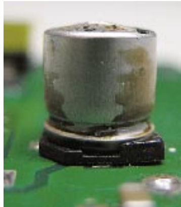
Har elektrolytkondensatorn utsatts för övertemperatur kan den vara litet bullig ovanpå och inte platt, som den skall vara.
